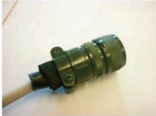
*USE AROUND THE CABLE ONE SHEATH TO INCREASE THICKNESS AND HAVE OPTIMUM CLOSING*
