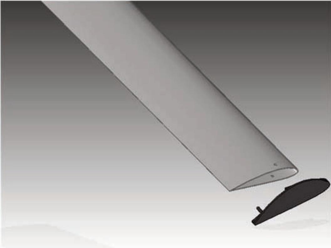
*POSITION THE WINGLET AT BLADE TIP
